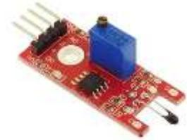
Raccordement sur une entrée analogique ou une entrée digitale d'une carte Arduino® ou compatible.
