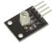
**Remarque :** nécessite l'ajout d'une résistance de limitation par couleur en fonction de la tension d'alimentation.
