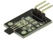
Il se différencie du capteur analogique par une résistance et une led intégrées au module.
