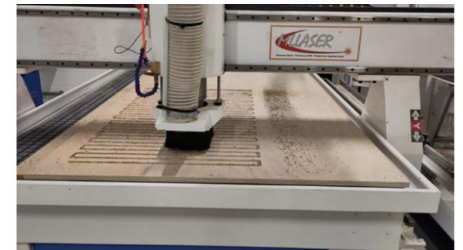
Le bord de la planche est usiné pour épouser complètement l'écran et le rendre étanche. L'écran récupéré possédant des joints en caoutchouc et plusieurs points d'attache. Le système sera juste compressé et vissé pour une étanchéité suffisante à l'air.
