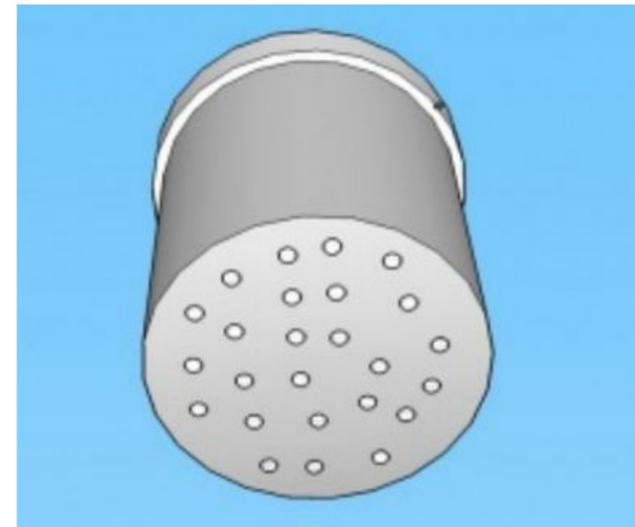
5- Percez un maximum de trous dans le couvercle d'un des pots. Ces trous permettront à l'air d'entrer dans le lombricomposteur sans que les vers ne puissent en sortir.
