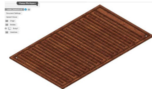
L'usinage a été réalisé à l'aide d'une CNC mais pourrait être réalisé d'autre manière. Le fichier est complètement paramétrique et pourrait donc être facilement modifié pour s'adapter à d'autres tailles d'écrans.
