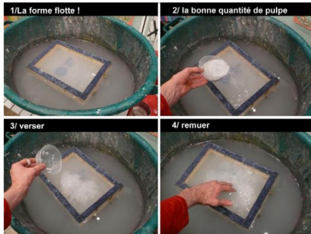
Remplissage du tamis (la forme) avec de la « soupe de papier » mixé. Image : atelier Yann Faclab.
