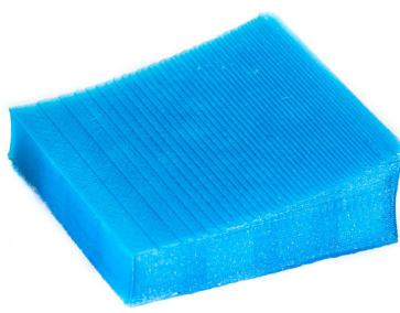
Comment la hauteur de couche affecte la surface de l'objet
